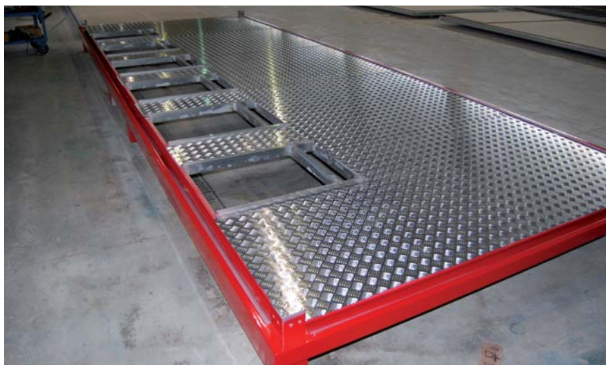
IL BASAMENTO è costituito da profilato/portapannello perimetrale zincato e da intelaiatura in tubolare zincato. È possibile fornire pavimentazioni differenti allo standard utilizzando multistrato fenolico (adatto ad ambienti umidi) o rivestire con Pvc omogeneo, gomma, alluminio mandorlato (come in questo specifico caso), vetroresina, e altro.
