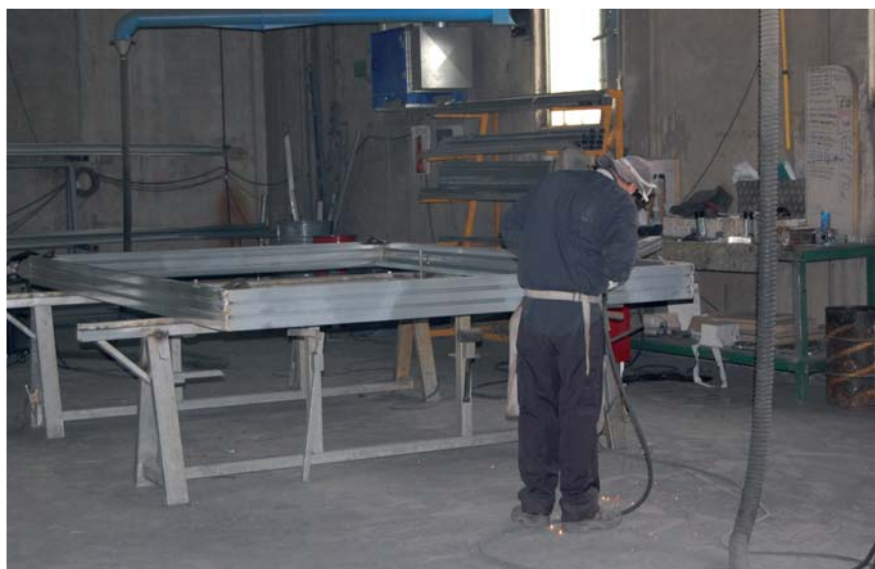
NEGLI SPAZI ORGANIZZATI DELLO STABILIMENTO HA LUOGO IL PROCESSO PRODUTTIVO. I profilati vengono saldati da manodopera specializzata. Il profilo perimetrale del tetto dopo la verniciatura e l'essiccazione, che avviene in appositi forni.
